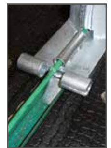
keskiohjurin leveä laakeri hitsattu rautatankoon
