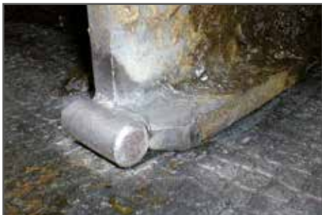
sivujalokset, joissa rautatanko ja leveä laakeri
