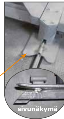
keskiohjurin leveä laakeri on taivutettu jalakseen muotoon
