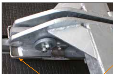
keskiohjurin leveä laakeri on taivutettu jalaksen muotoon
