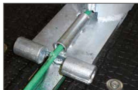
keskiohjurin leveä laakeri hitsattu rautatankoon
