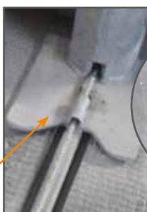
keskiohjurin leveä laakeri on taivutettu jalaksen muotoon
